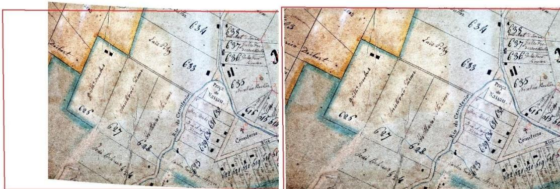
Figura 5. Fotografia após o georreferenciamento utilizando, respectivamente, a transformação Adjust e Projective Transformation.
